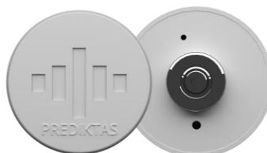
Le PrediTag est sans fil, il s'aimante rapidement sur n'importe quel type d'équipement et transmet ses données via les réseaux nationaux SigFox ou LoRa, assurant un déploiement en quelques secondes. Les données sont analysées par des algorithmes d'intelligence artificielle tout en étant consultables sur une plateforme web et une application mobile.
